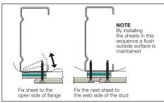
FIGURE 4 SCREW FASTENING
