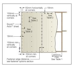
FIGURE 5 SHEET FASTENING SPACING
