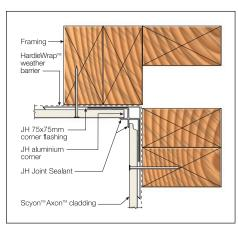
FIGURE 20B ALUMINIUM INTERNAL CORNER
