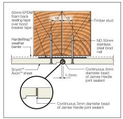
FIGURE 22 VERTICAL BUTT JOINT
