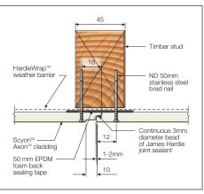
FIGURE 10 BRAD NAIL FIXING
